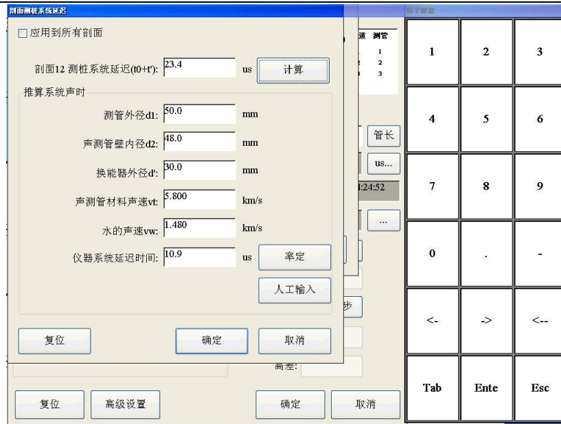
图 6: 剖面 12 测桩系统延迟
