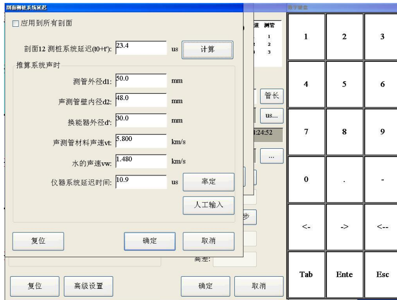
图 2：12 剖面测桩系统延迟
